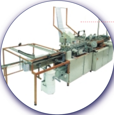
Aspiration des débris de opérations de découpage de matériel d'emballage.
