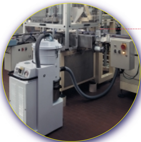
Succion ponctuelle sur une ligne de production.
