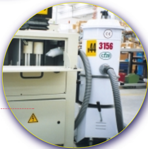
Installation fixe sur des machines équipées de laser.
